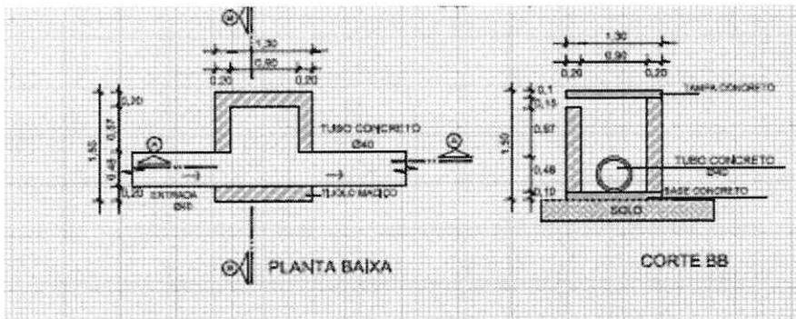
As caixas coletoras são dispositivos a serem executados junto às redes laterais, em áreas urbanizadas, com o objetivo de captar as águas pluviais e conduzi-las a rede condutora. Será construída com paredes laterais que serão em alvenaria de tijolo maciço, com espessura mínima de 20cm, com uma base de concreto, fck 20 MPa, espessura de 10cm. A laje de
