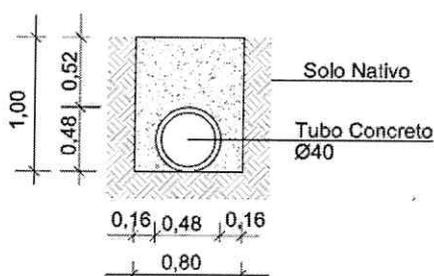
As valas que deverão ser abertas preferencialmente no sentido de jusante para a montante e executadas em caixão (talude vertical), a partir dos pontos de lançamento ou de pontos onde seja viável o seu esgotamento por gravidade, caso ocorra presença de água durante a escavação. A Executante dos serviços, para garantir as condições de segurança para todos e o trânsito geral, o trecho deverá ser sinalizado e protegido contra os riscos de acidentes.
