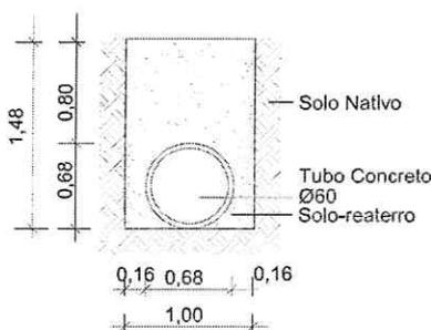
As valas que deverão ser abertas preferencialmente no sentido de jusante para a montante e executadas em caixão (talude vertical), a partir dos pontos de lançamento ou de pontos onde seja viável o seu esgotamento por gravidade, caso ocorra presença de água durante a escavação. A Executante dos serviços, para garantir as condições de segurança para todos e o trânsito geral, o trecho deverá ser sinalizado e protegido contra os riscos de acidentes.
